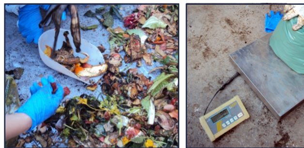
Εικόνα 2. Διασикаσία διαλογής και ζύγισης των ΑΣΑ του Δήμου Νάξου και Μικρών Κυκλάδων
